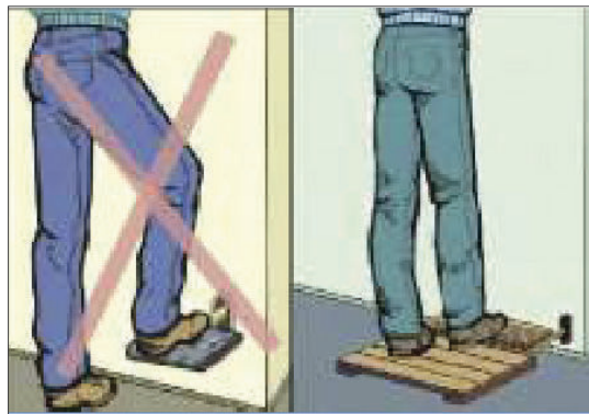
Görsel 3.27: Pedal kullanarak yapılan çalışmalarda yanlış ve doğru ergonomik tasarımlar
