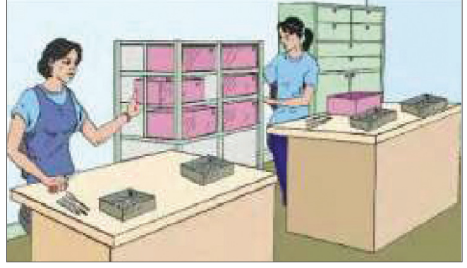
Görsel 3.16: İş bölümlerine ara stok raflarının konması ve ürünün direkt geçişinin sağlanması
