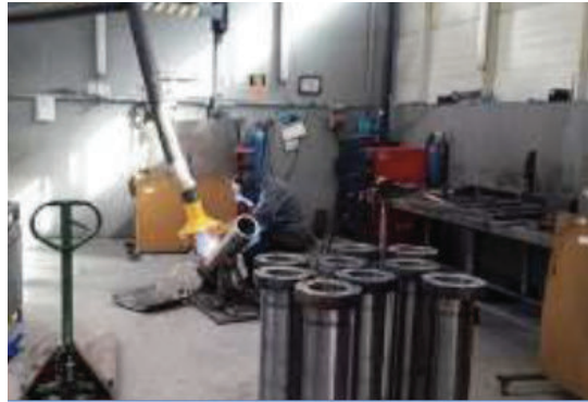
Görsel 3.33: Lokal havalandırma örneği
