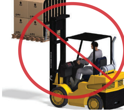
Görsel 3.39: Çatallar yukarıdaki iken hareket eden bir operatör
