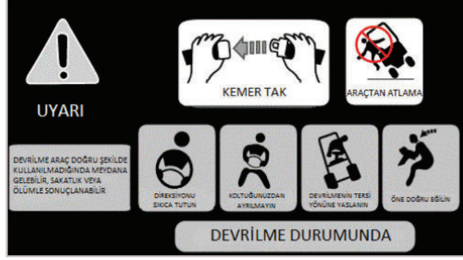
Görsel 3.42: Forklift devrilmesi durumunda yapılacaklar
